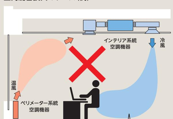
午後になり気温が上がると冷房が自動的に起動し、エネルギー効率が非常に悪い状態が発生します。
