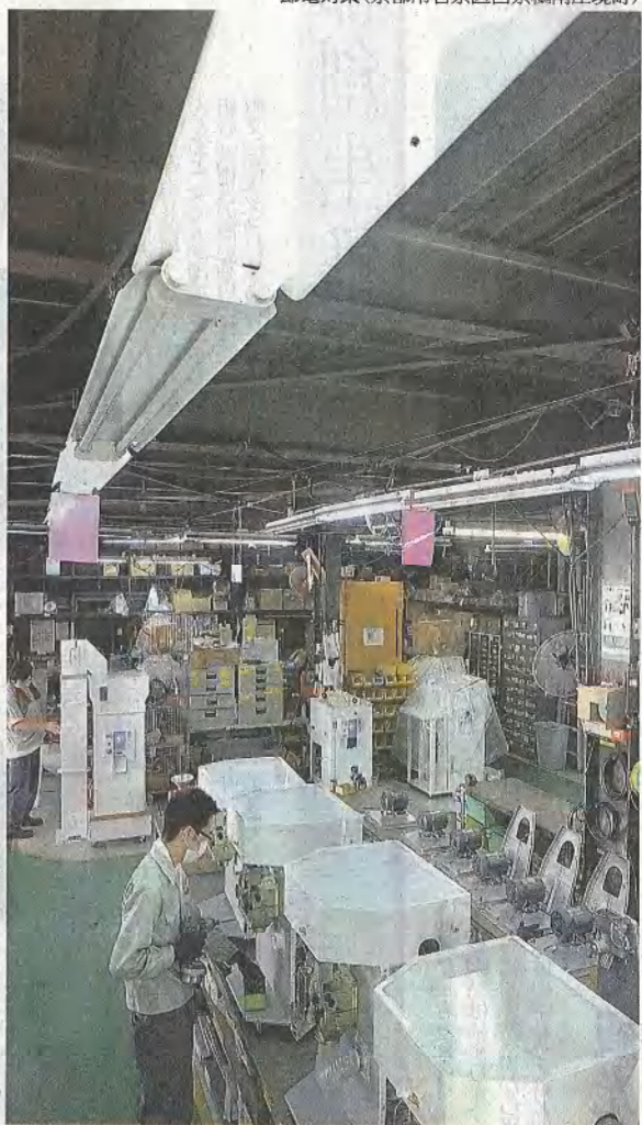
色紙で蛍光灯とスイッチの対応を分かりやすく示し、照明を減らした宝田工業の節電対策(京都市右京区西京極南庄境内)
